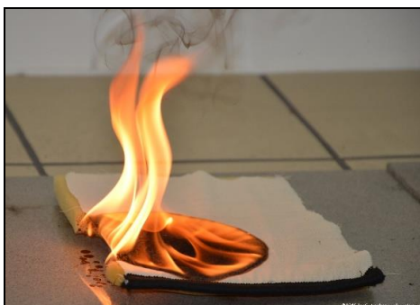
Obr. 6 Iniciace textilie z vnitřní strany dětského kočárku dotykem hořící prskavky
