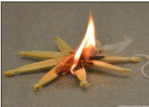
Obr. 4 Slaměná ozdoba iniciovaná jiskrou
