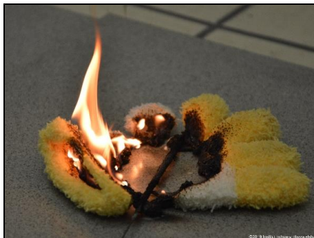
Obr. 5 Dětská rukavice iniciovaná odloženou hořící prskavkou
