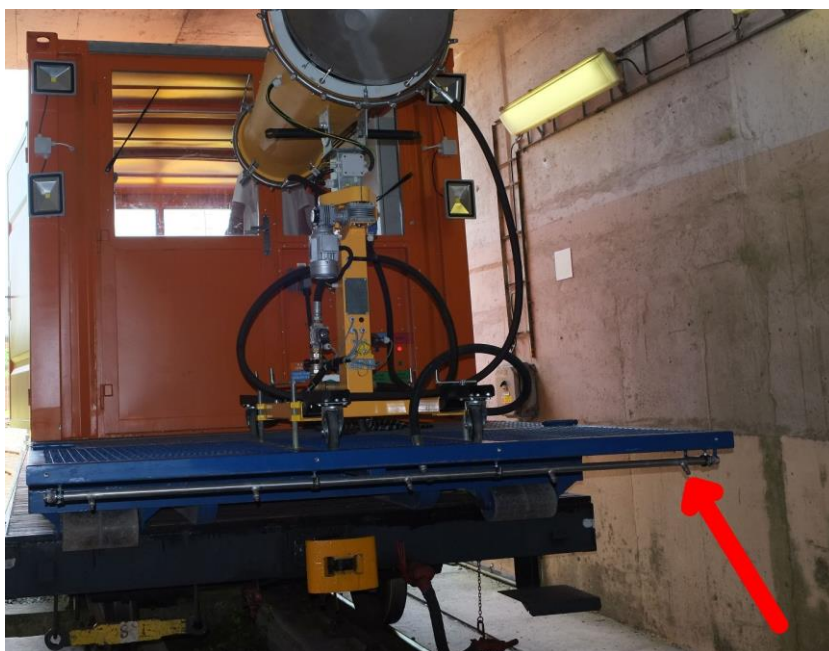
Obr. 5 Lišta s tryskami na DA4
