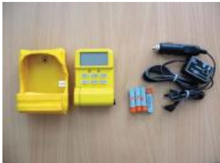
Obr. 2 Zásahový dozimetr Ultraradiac URAD 115 [17]
