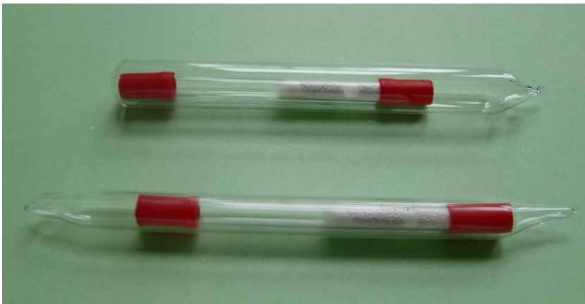
Obr. 6 Trubička uzavřená plastovými zátkami a zatavená ve skleněné trubici (zkumavce)
