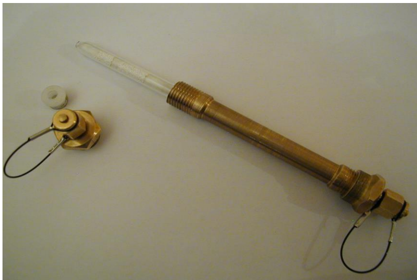
Obr. 3 Vyjmutí sorpční trubičky z plynotěsného pouzdra
