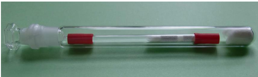
Obr. 5 Trubička uzavřená plastovými zátkami uložena v zábrusové zkumavce
